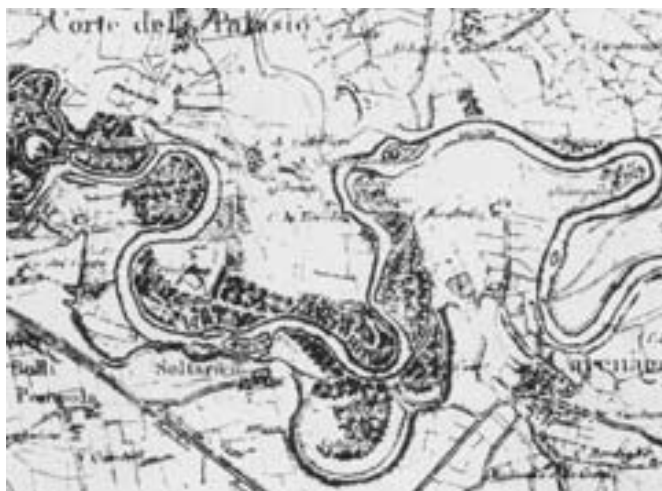
Fig. 3.1 – Situazione dell'Adda nel tratto della Lanca di Soltarico prima del salto di meandro che ha originato la zona umida attuale. In alto una cartografia del 1833, in basso del 1889.
